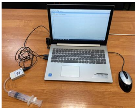
Рис. 1. Экспериментальное подтверждение закона Бойля–Мариотта [19, с. 110]
